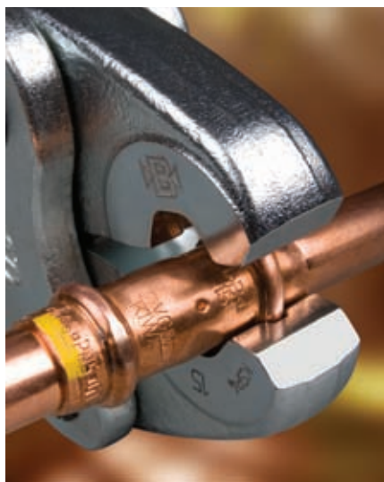
2. Szczęki do wykonywania połączeń zaprasowywanych
