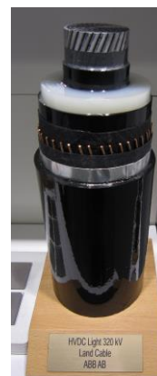
Rys. 9 Próbka kabla HVDC Light na napięcie 320 kV (fot. autorka)
