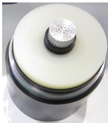
Rys. 8 Próbka kabla o izolacji XLPE prądu przemiennego 800 kV (fot. autorka)
