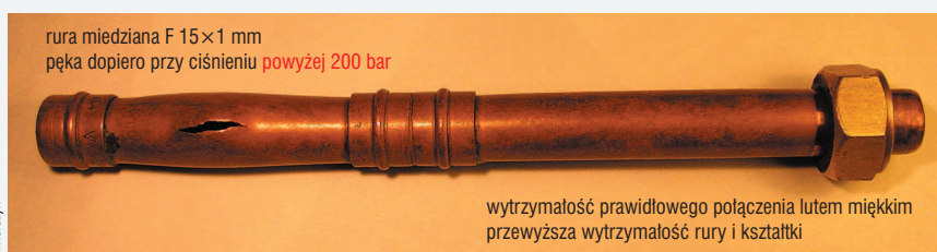
Fot. 3. Rura miedziana z prawidłowo wykonanymi połączeniami lutem miękkim – uszkodzeniu uległa sama rura, a nie połączenia
